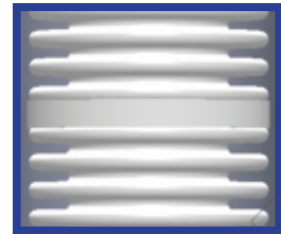
多层波纹管，设置导向结构，防止失稳
